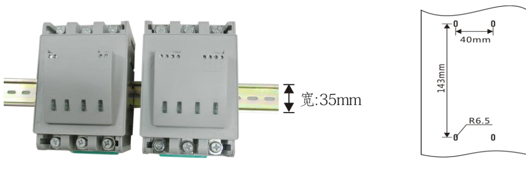
导轨安装方式
